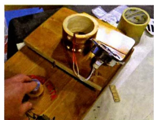
Запаиваем кнопку включения и сетевой провод. Перед сборкой проверяем работу электроцепи.
