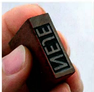
Объёмная или глубокая гравировка наносится в несколько проходов, высота буквы может быть до 0,5 мм.
