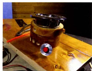
Приклеиваем «стакан» к нижней части полки. С обратной стороны «станана» просверлено несколько отверстий для вентиляции.
