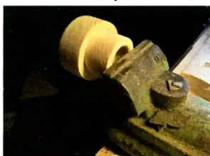
Большую красную кнопку не нашёл, купил бескорпусную. Корпус для неё сделал из колец. Два кольца склеиваются на «Тайтбонде». Если заготовки зажать в тисках, клеевое соединение получается очень надёжным.
