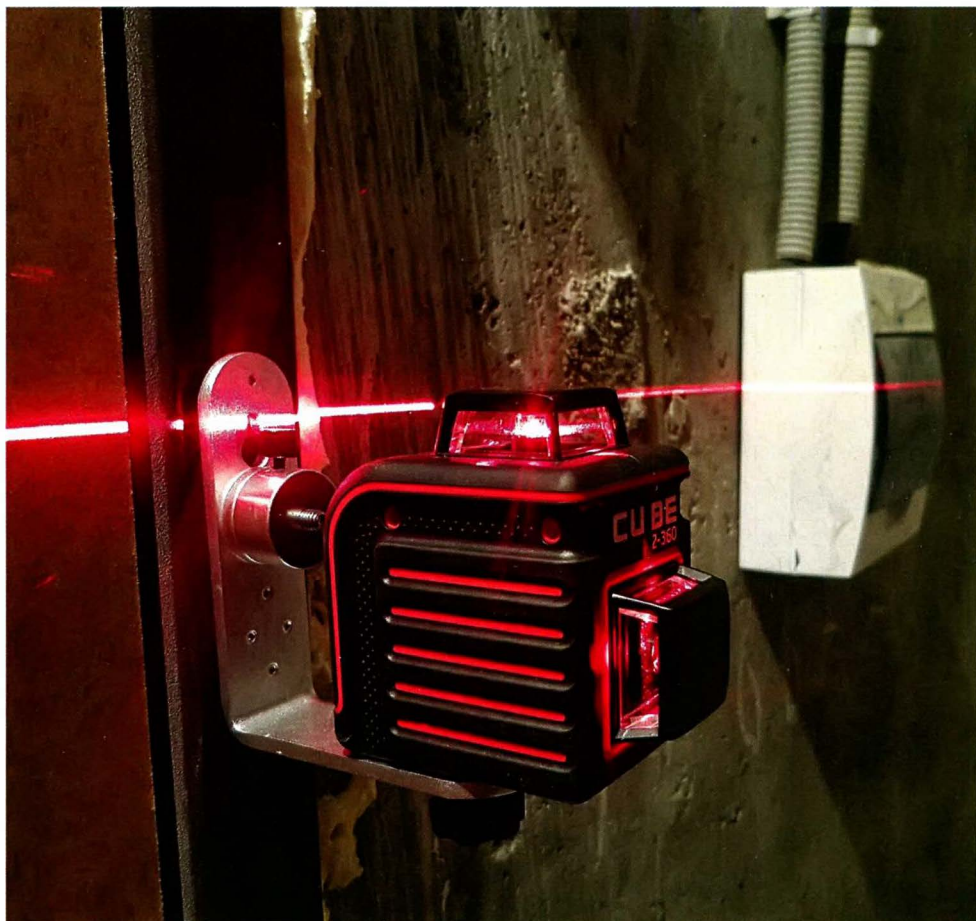
В качестве примера рассмотрим и сравним с конкурентами зарекомендовавший себя у профессионалов лазерный нивелир ADA CUBE 2-360. Данный уровень имеет два лазерных излучателя, проецирующих лучи на 360 градусов.
