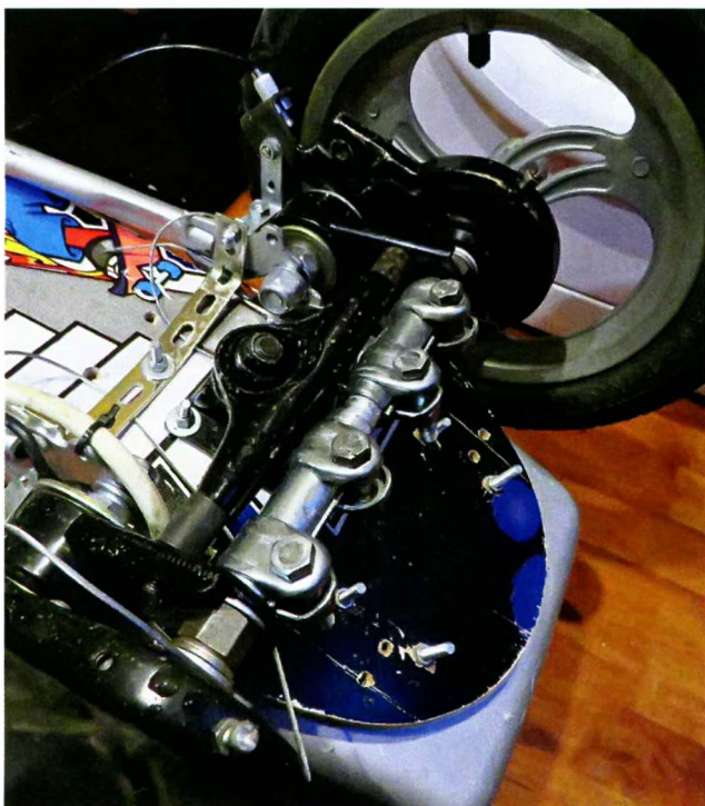
Основа задней оси получилась разборной, так как не мог подобрать целую ось. Подошёл комплект крепления рулевых тяг на классику ВА32101. Поворотный механизм — полностью от доски скейтборда, переходники от механизма поворота к задней оси сделаны с помощью крепежа для строительных лесов. Всё встало. Доска от скейта крепится к раме на болтах. Задние колёса — литые от китайского скутера, диаметр 12 дюймов.
