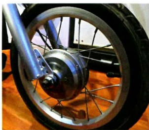
Мотор-колесо легко устанавливается вместо колеса велосипеда. Диаметр колеса 14 дюймов.
