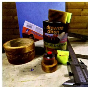
Теперь покрываем стакан пропиткой на основе тунгового масла, обычная ёлка приобретает цвет благородного тика.
