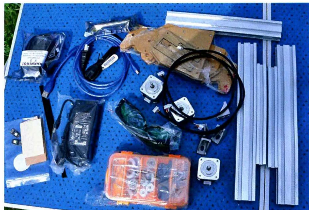
Поставляется лазерный гравер 5500mw A5 Mini Laser Engraving Machine в виде комплекта для сборки: алюминиевые направляющие, шаговые двигатели, плата управления, очки для защиты глаз от лазерного излучения, детали корпуса для сборки и плата управления с фурнитурой. Чтобы собрать девайс, понадобился один вечер.
