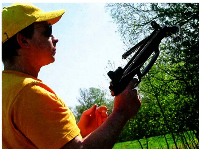
Арбалет готов к выстрелу. Вес арбалета — 1,5 кг, размах дуг — 47 см, длина — 40 см, ход тетивы — 21 см. При стрельбе по мишени ну очень не хватает откидного приклада.
