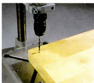
Отверстия должны быть просверлены строго перпендикулярно доске. Лучше для этой операции использовать сверлильный станок.
