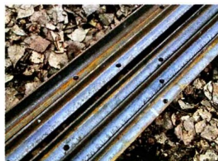
Отверстия диаметром 9 мм для прутков.
