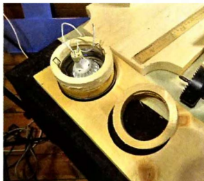
«Станок» под спот склеен из трёх деревянных колец. Кольца вырезаны из той же еловой доски с помощью аккумуляторного шуруповёрта и набора кольцевых пил отечественного производства.
