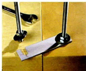
При стыковке по длине двух полок их следует соединить вот такой металлической пластиной.
