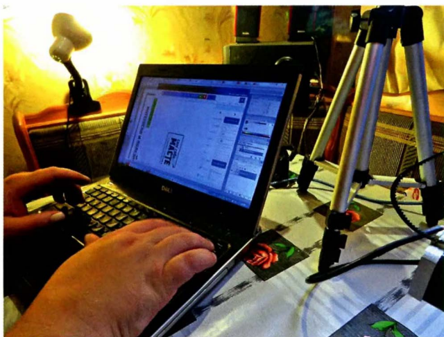
Экспортируем рисунок из векторного редактора SketchUP или Corel draw в программу гравера VenBox.
