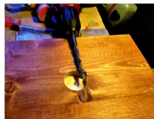
Внутри полки просверлено отверстие диаметром 8 мм, по которому будем тянуть провод к лампочке.
