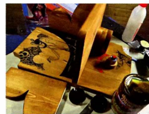
Все детали покрыты пропиткой на основе тунгового масла с тоном «Тик». После чего покрыты 2-3 слоями яхт-лака.
